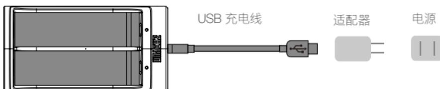
**💡** ①由于充电器本身差异，供电不足的情况下（比如适配器电流小于 500mA），无法启动充电过程，以致使电池不能同时充电，建议使用更大电流的适配器。
