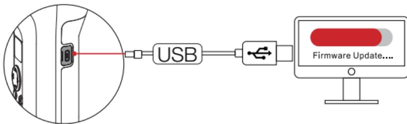
方法一：使用 Type-C USB 数据线连接稳定器 USB 接口和电脑，用于稳定器的固件升级和联机校准。
