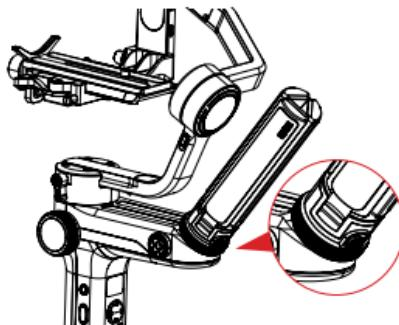
**⚠ 在手提使用前，请务必**将三脚架锁定开关拨到锁定状态。
