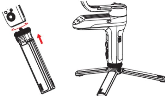
您也可以将三脚架安装至电池仓座上，进行手提使用。
